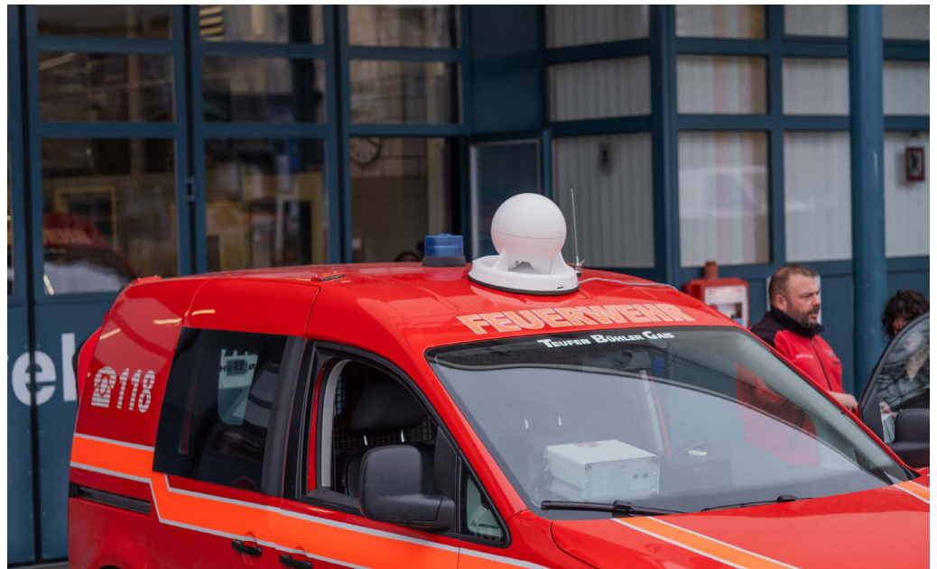
Die beiden mobilen Sirenen auf dem Autodach sind rund um das Dorf und bis Battenhaus, Lustmühle, Nieder-teufen unterwegs. Im Notfall sollen so alle gewarnt werden können. Fotos: tiz
