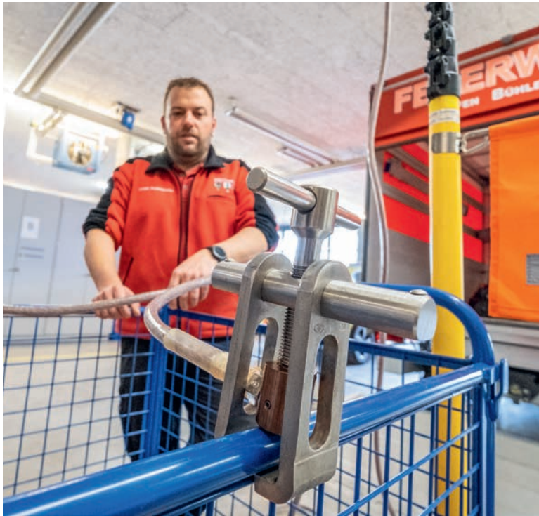
Diese Klammern werden im Notfall an den Schienen montiert. Sie sind via Kupfer-Leiter mit dem Haken an der Fahrleitung verbunden. Foto: tiz
