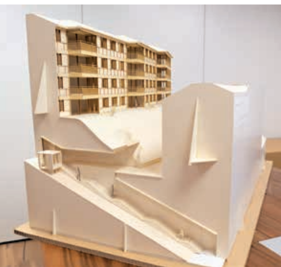
Das Modell zeigt, wie der rund 80 Meter lange Schräglift die drei Wohnblöcke verbinden soll. Foto: tiz
