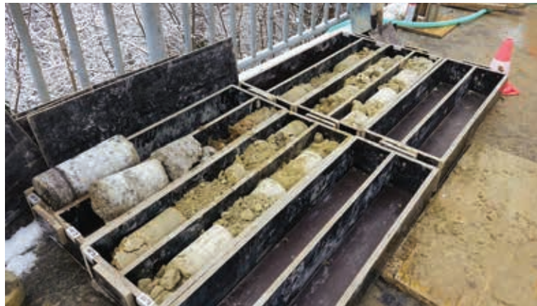
Die Bohrkerne werden in Kisten von je einem Meter Länge deponiert.
