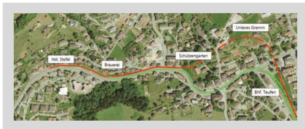
Vergleich der Linienführungen beim Kurztunnel (rot) und bei der Doppelspur (grün).
