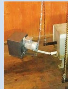
Die Lösung für die Dämpfung des Stundenschlags stammt von der Firma Muff AG Kirchturmetechnik in Triengen. Zum bestehenden mechanischen Hammerhebewerk, welches mit einem Motor den Hammer anhebt
