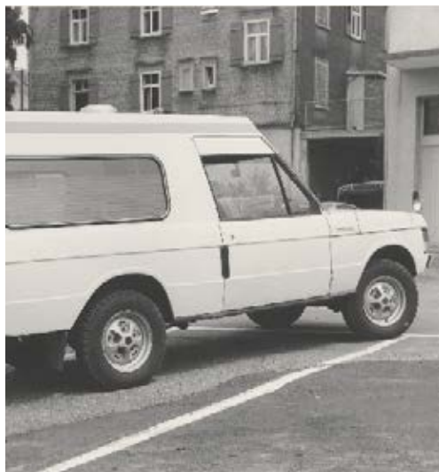
Als Nachfolger für den seit 1958 in Betrieb stehen- den Mercedes schaffte das Krankenhaus Teufen im Sommer 1975 einen «Range Rover» an. «Sein Allradantrieb, die Hochlage der Radachsen und seine gegenüber normalen Krankenwagen geringere Länge erlauben das Befahren der in unserm Gelände häufig anzutreffenden schlechten Strässchen mit tief aus- gefahrenen Leisen.» (Foto vom 21. Juli 1975)
