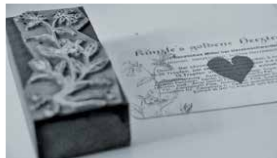
Druckstock (Zinkcliché) für Illustrationen.
