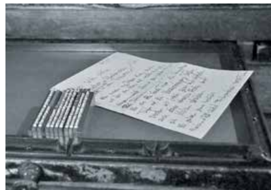
Der gegossene Zeilensatz aus der Linotype.
