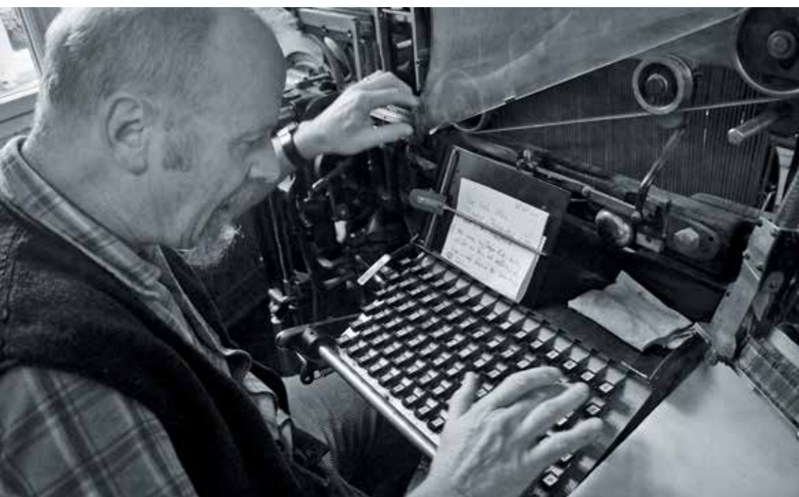
Das Handmanuskript wird auf der fast hundertjährigen Bleisetzmaschine eingetippt.
