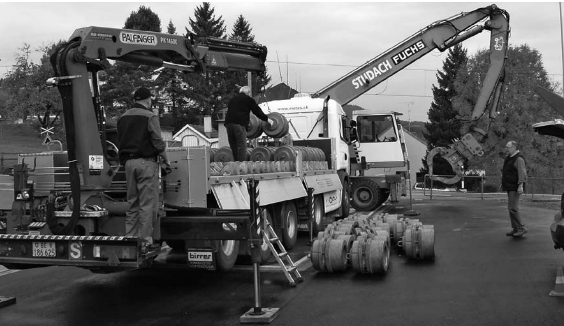
Die neue Brückenwaage beim Transportgeschäft Studach wird geeicht. Foto: pd.
