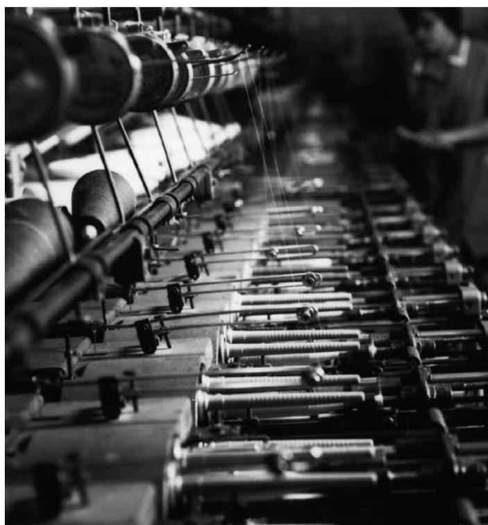
Fertigung der Fadenspulen für die Schnellschützen (Webschiffchen).
