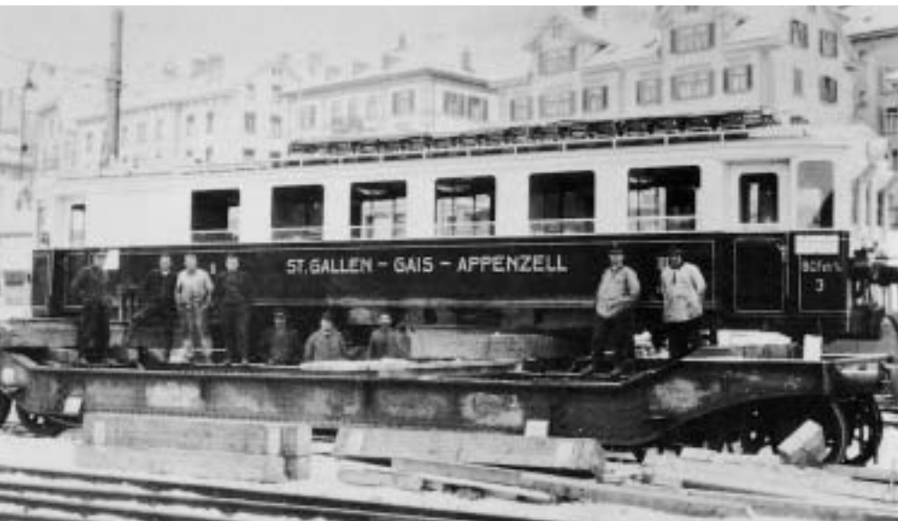
Mit vereinten Kräften wurden im Güterbahnhof St.Gallen die Wagenkästen der neuen Triebwagen von Tiefladewagen der SBB auf die eigenen Fahrgestelle geschoben. Dezember 1930.
